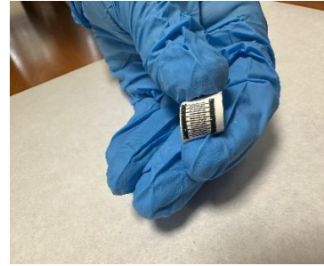
Şekil 2.. Esnek kağıt alttaş üzerine karbon dedektörümüz
